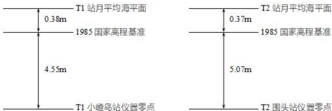
图 4.2-4 2 个潮位站的基面关系图(2024 年春季)
